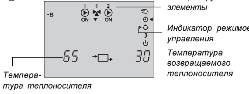
Для того, чтобы увидеть расчетные уставки расхода и температуры возвращаемого теплоносителя, нажмите кнопку сдвига.
