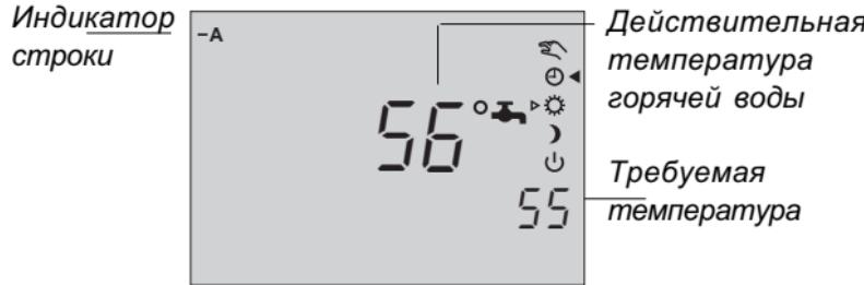
Для контроля температуры горячей воды выбрать этот дисплей.
