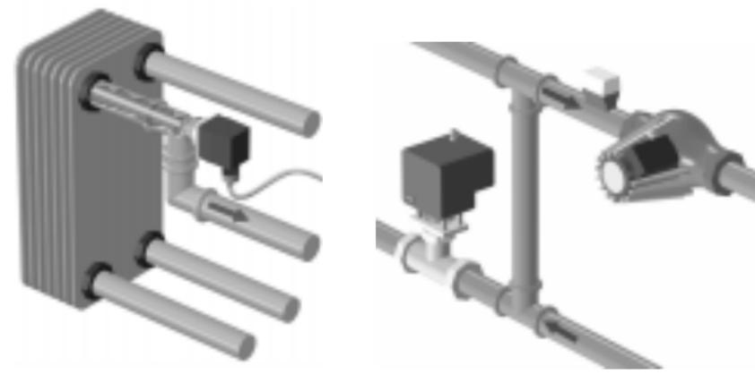
После закрепления поверхностного датчика для предотвращения повреждений его термо чувствительного элемента перемещение датчика запрещено.
