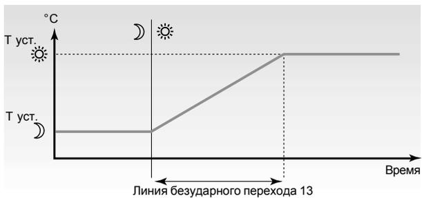
Для предотвращения пиков нагрузки в сети питания может быть установлено задание для медленного увеличения температуры теплоносителя после периода пониженной температуры. Это обеспечивает медленное открытие клапана.
