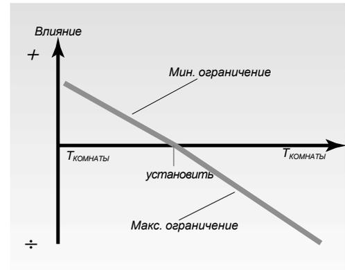
Комнатный датчик в характерном помещении регистрирует разность между требуемой и действительной температурами воздуха в помещении. Задание температуры теплоносителя будет скорректировано для устранения этой разности.
