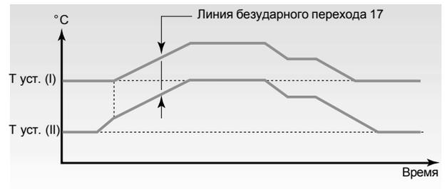
Задание температуры в контуре отопления I может зависеть от другого внутреннего или внешнего задания. Установленное число определяет зависимость задания температуры теплоносителя в контуре II или сигнала задания от другого подключенного регулятора ECL, или собственного регулятора контура II.
