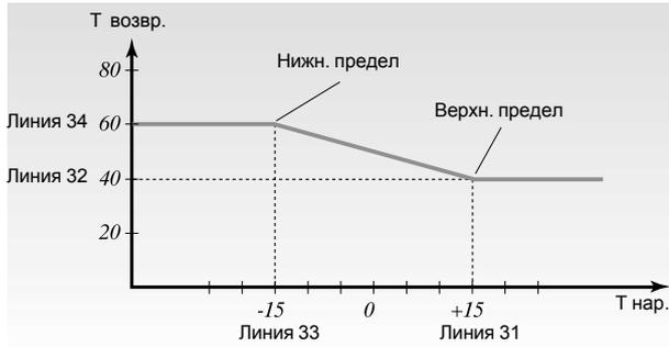
Ограничение температуры возвращаемого теплоносителя основывается на температуре наружного воздуха. Если температуре наружного воздуха падает, то может быть установлена наивысшая температуры возвращаемого теплоносителя, если это требуется.
