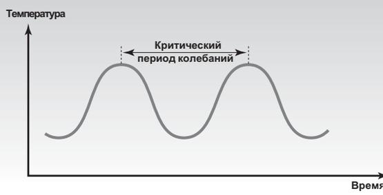
Критический период колебаний - характерная особенность оборудования и Вы можете выполнять ввод установочных значений с помощью критического периода колебаний и зоны пропорциональности в пределах этого периода колебаний: Постоянная интегрирования = 0,85 x значение критического периода колебаний
