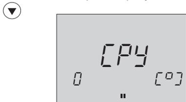
⊕ Для записи всех без исключения установочных значений, регулировок и т.п. на электронную карточку ECL нажмите кнопку с плюсом.
